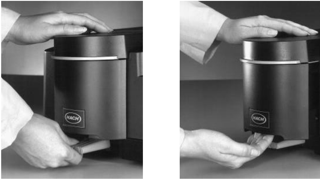
图 7 开启模块锁和取出模块
